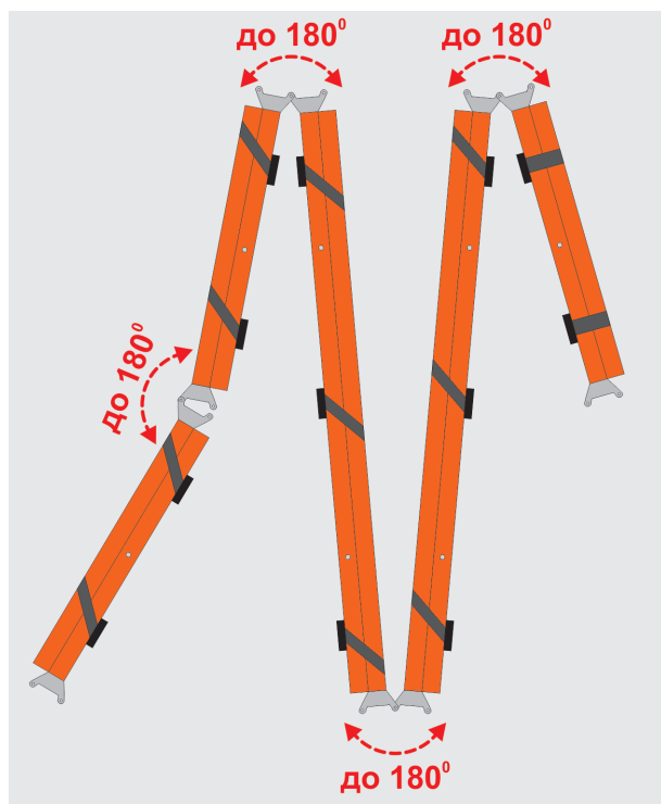
«ГАСТРАП» схема складывания/раскладывания (вид сбоку)
